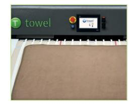
Die Artikel werden auf das Eingabeband gelegt. Dieses Förderband beginnt zu laufen, sobald das Artikel detektiert wird oder nach einer manuellen Aktivierung mittels einer Taste auf der Seite der Maschine.
